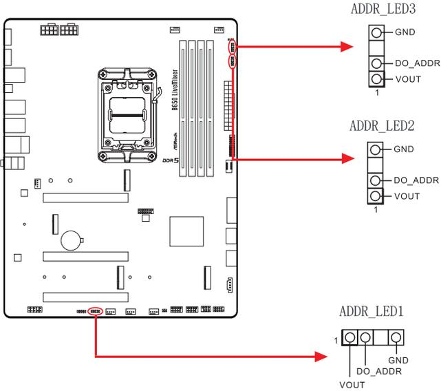
将可寻址 RGB LED 灯条连接到主板上的可寻址 LED 接脚 (ADDR\_LED1 / ADDR\_LED2 / ADDR\_LED3)。
